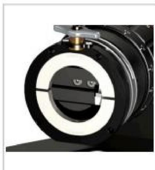
Широкое открытие зажима для лёгкого позиционирования трубы
