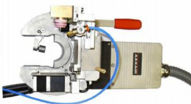
Орбитальная сварочная головка с AVC-контролем и колебаниями дуги
