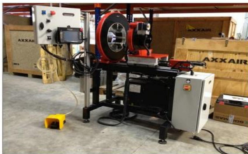
Установка для орбитальной сварки с удержанием свариваемых деталей на прихватках
