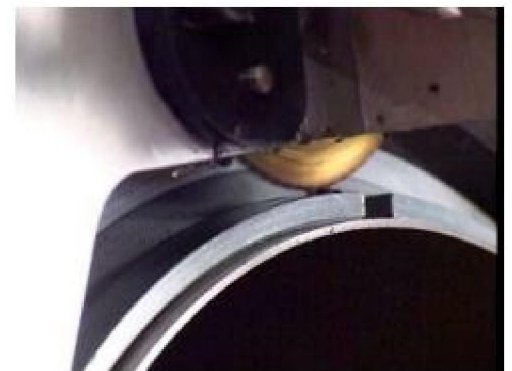
Линия для орбитальной резки труб большого диаметра и тонкостенных титановых труб
