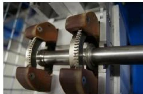
Орбитальная сварка с двойной сварочной головкой
