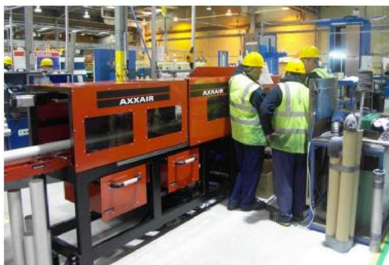
Автоматическая линия для высокоточной орбитальной резки титановых труб
