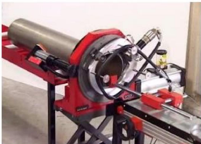
Линия для орбитальной резки труб большого диаметра и тонкостенных титановых труб
