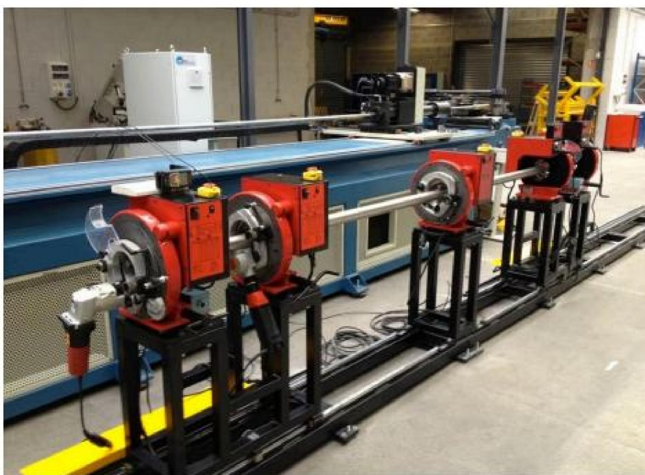
Орбитальная резка скоса кромки и линия для сварки труб на рельсах
