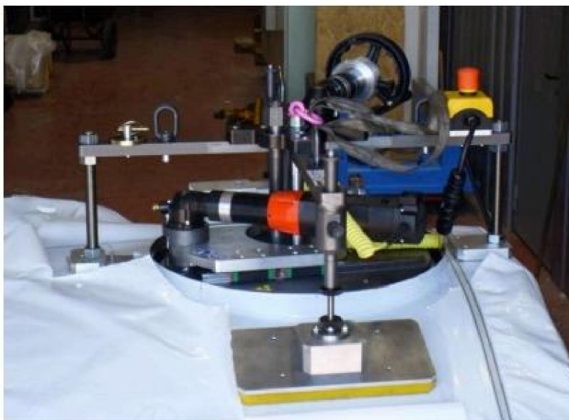
Внутренняя орбитальная резка отверстий нержавеющей баков
