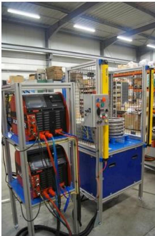
Орбитальная сварка с двойной сварочной головкой
