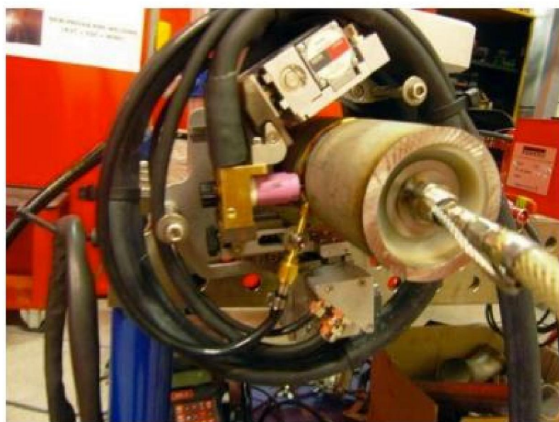
Орбитальная сварочная головка с AVC-контролем и колебаниями дуги
