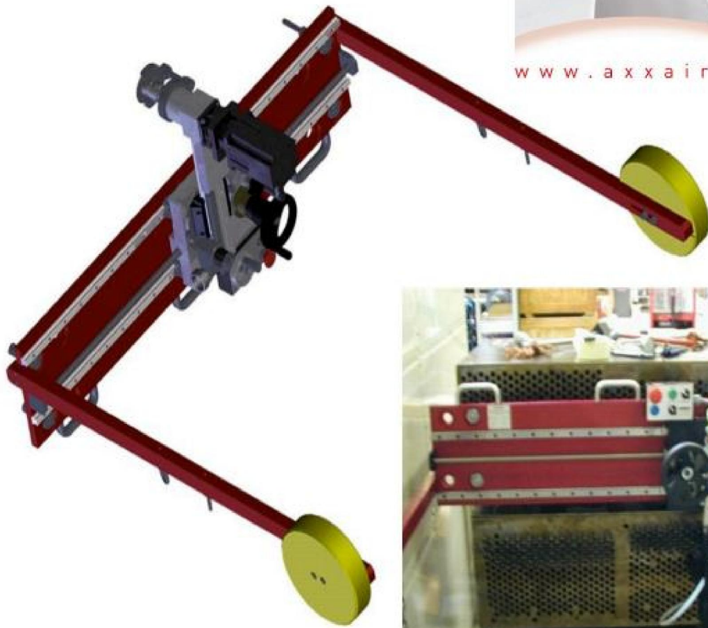
Обрезка труб из инконеля на трубной решетке теплообменника
