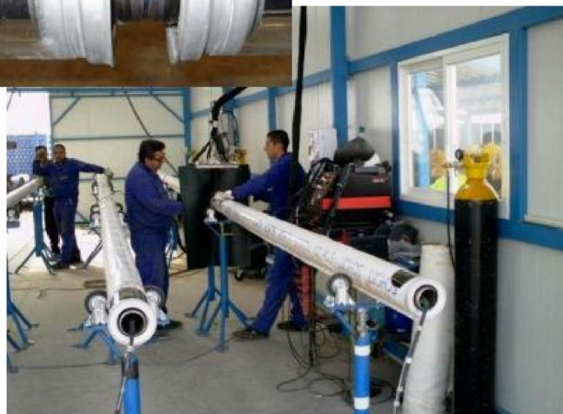
Орбитальная сварка труб "SCHOTT" для солнечной электростанции
