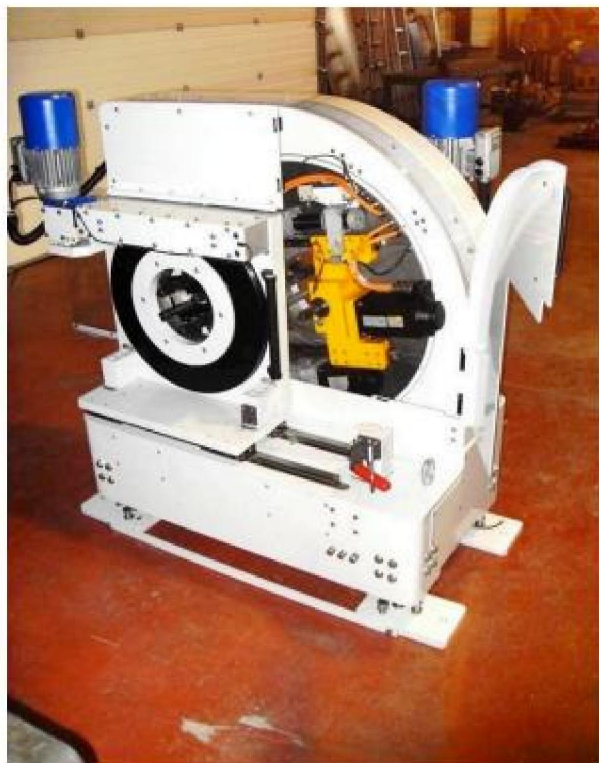
Промышленная установка для орбитальной резки двумя фрезами
