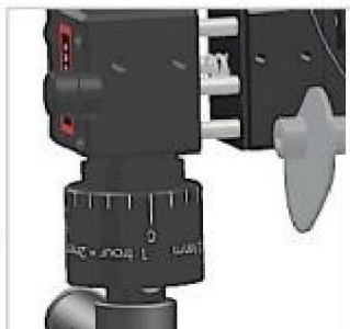
Радиальная регулировка для точного позиционирования электрода
