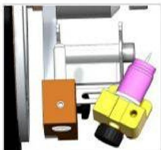
Регулировка угла горелки: сварка фланцев или Т-образных стыков
