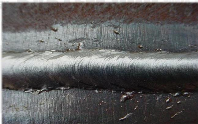
Механизированная сварка MIG
