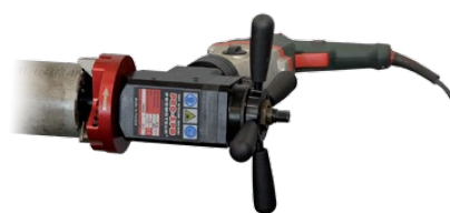
PRO-5 PB • Pipe ID 32 mm up to OD 114 mm (option: ID 25 - 32 mm) (option: OD 140 mm) • J-groove beveling
