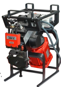
ABM-14 • Bevel width up to 14 mm • Bevel angles: 22.5°, 25°, 30°, 35°, 37.5°, 45° • Top & bottom beveling
